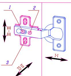
*Ослабить шурупы (3) выравнять дверь по высоте и снова затянуть шурупы.*
