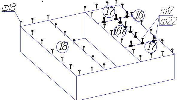
*Начните сборку каркаса. Проверьте перпендикулярность и параллельность щитов и зафиксируйте с помощью задней стенки из ДВП, как указано на рисунке, не нарушая диагонали. Помните, что от этого зависит правильности работы выдвижных ящиков*
